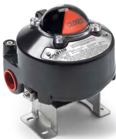
Механический концевой переключатель (сертификат ATEX) для применения в зонах с классом опасности 2, температурный диапазон от -20 до 60 °C (от -4 до 140 °F)
