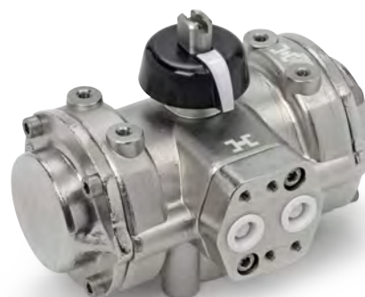
Стандартный пневматический привод из нерж. стали с поворотом на 90°, макс. рабочее давление 8 бар (116 фунтов/кв. дюйм). Стандартный диапазон рабочих температур: от -32 до 90 °C (от -25,6 до 194 °F)
