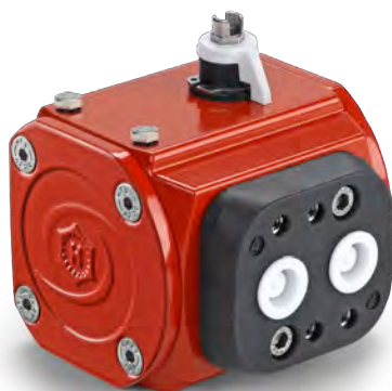
Стандартный с поворотом на 90 градусов. Стандартный алюминиевый пневматический привод, рабочее давление: макс. 8 бар (116 фунтов/кв. дюйм). Стандартный диапазон рабочих температур: от -32 до 90 °C (от -25,6 до 194 °F)
