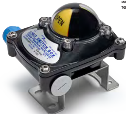
Индуктивный концевой переключатель для визуальной и электрической индикации напряжения положения привода: 8 В пост. тока, степень защиты оболочки IP67
