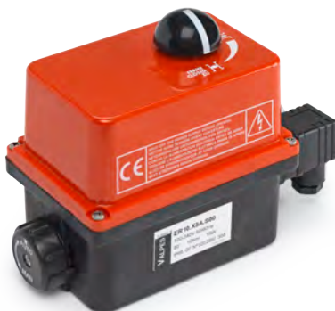
Электропривод предназначен для управления клапаном с поворотом на 90°. Мощность 15 Вт, степень защиты оболочки IP66. Вариант 1: 90–240 В, 50/60 Гц, 90–350 В пост. тока Вариант 2: 15–30 В, 50/60 Гц, 12–48 В пост. тока
