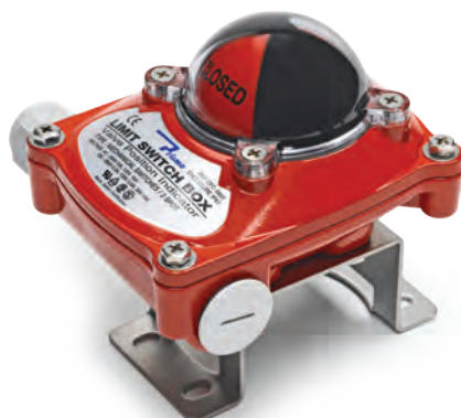
Электропневматический концевой переключатель для визуальной и электрической индикации положения привода. Степень защиты оболочки IP67, напряжение: переменный ток: 250 В, 16 А; 125 В, 16 А; постоянный ток: 250 В, 0,3 А; 125 В, 0,6 А; 30 В, 10 В
