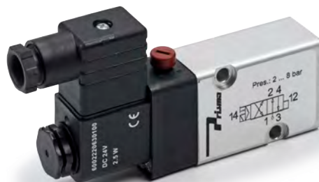
Электромагнитный клапан, подсоединяемый к приводу для управления шаровым краном. 24 В пост. тока, 2,5 Вт, 4/2-ходовой для реверсивного и пружинно-возвратного привода. Степень защиты оболочки IP65 Дополнительно для: 110 В перем. тока, 50 Гц. Дополнительно для: 3/2, 5/2-ходовые.
